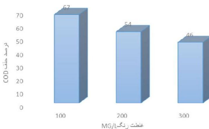
شکل ۶. میزان کارایی فرآیند Mn^{2+}/H_2O_2 در کاهش COD در شرایط بهینه فرآیند (pH=۳، غلظت Mn^{2+} ۲g/L و غلظت H_2O_2 ۴ ml/L)
