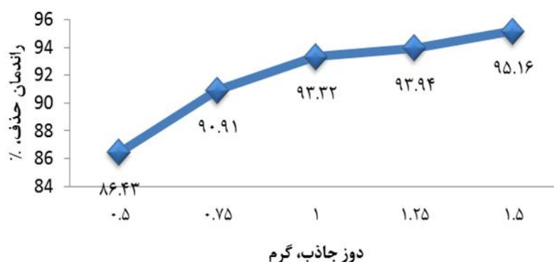
شکل ۵. تأثیر دوز جاذب بر راندمان حذف نیتروژن آمونیاکی (غلظت اولیه نیتروژن آمونیاکی ۱۵۰ mg/l، زمان تماس ۱۲۰ دقیقه و pH=۹)
