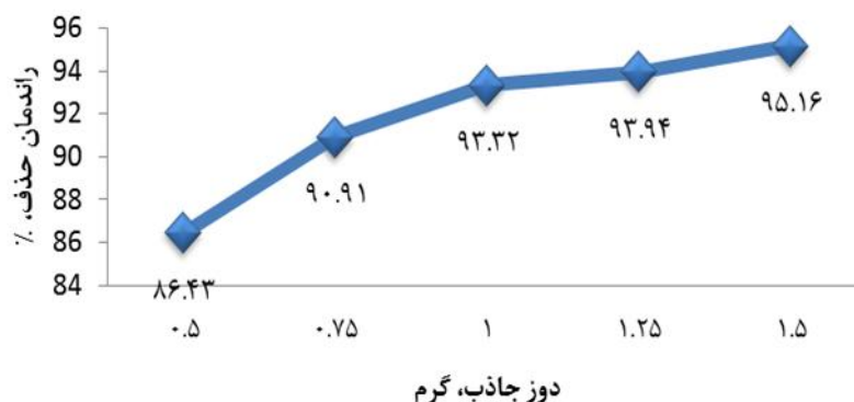
شکل ۵. تأثیر دوز جاذب بر راندمان حذف نیتروزن آمونیاکی (غلظت اولیه نیتروزن آمونیاکی ۱۵۰ mg/l، زمان تماس ۱۲۰ دقیقه و pH=۹)
